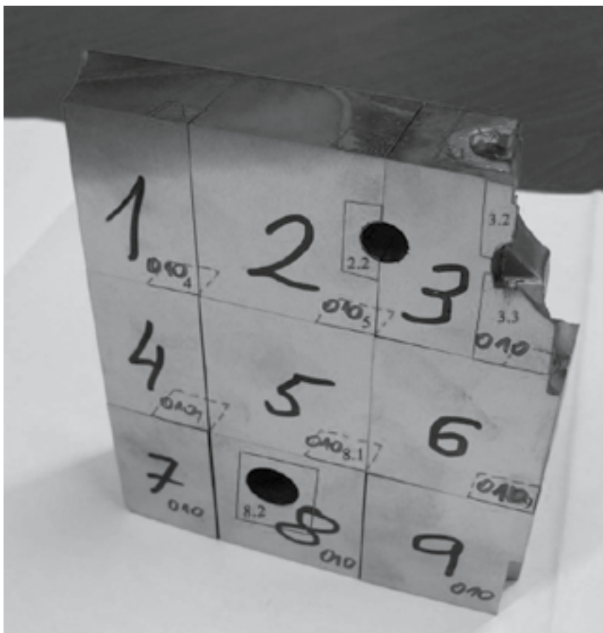
Obr. 1 Odběr vzorků z vložky – označena sledovaná místa s výbrusy
