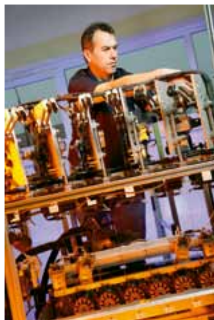
Statory budúcich elektrických posilňovačov riadenia na navíjačke
