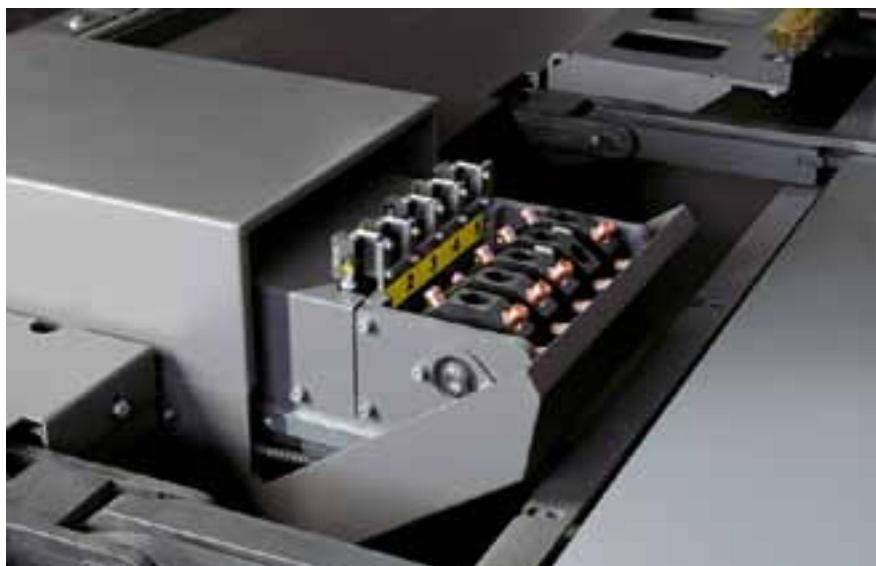
Menič trysiek Bystronic – vyznačuje sa vysokou kapacitou a jednoduchou manipuláciou
